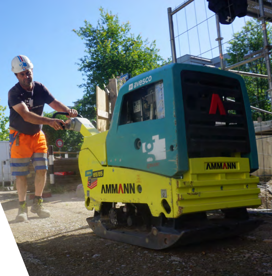
Le système breveté d'excitation à trois arbres rend le compacteur à plaques facile à contrôler.
