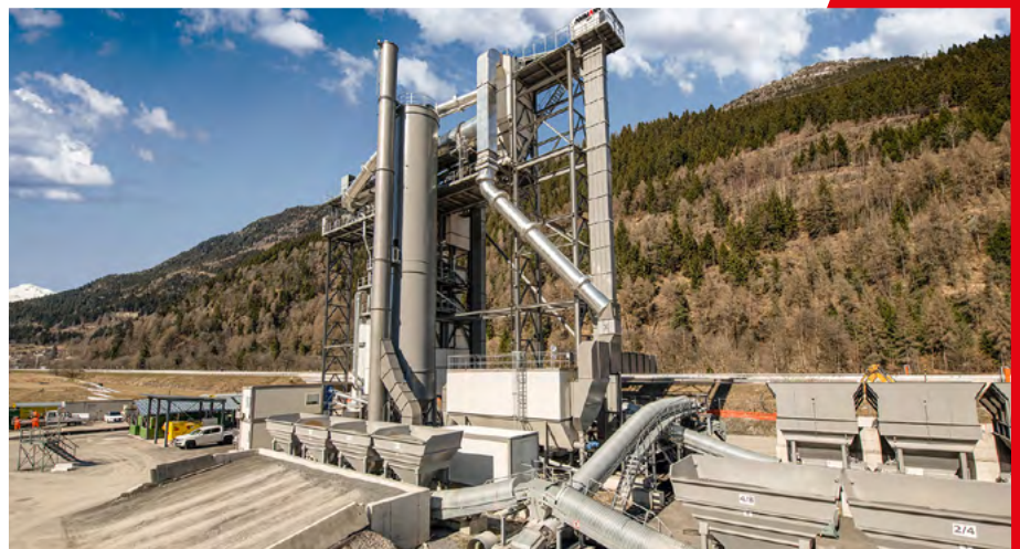
Una planta mezcladora de asfalto ABP HRT de Amman, que producirá un total de 250.000 toneladas de asfalto in situ.
