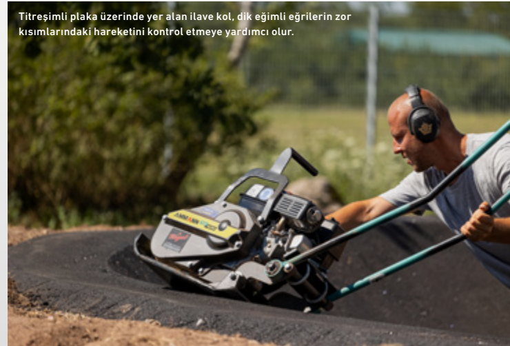
Plaka dışbükey bir şekilde işlenmiştir. Bu, kavislerin mükemmel şekilde modellenmesini sağlar.
