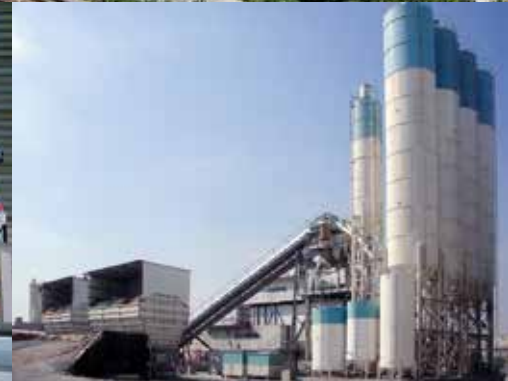
Centrale à béton EBC B 200 (Qatar).
