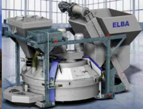
Module EM-L (fabrication d'éléments en béton).
